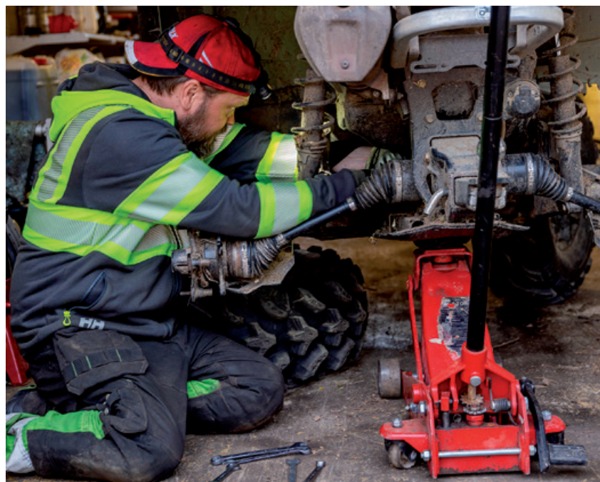
Tero Ailasmäki mönkijän ristinivelen vaihtotyössä. Kuva Risto Pöyliö
